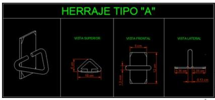
Platina de 3mm de espesor con dimensiones de 12 cm X 5 cm, la cual posee varios dobleces esquineros con el fin de no permitir que la cinta metálica de sujeción se deslice.
