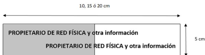
**Ejemplo de espiral para colocar adhesivo**
