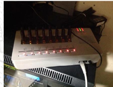
Foto 6. Equipo MODEM SIMBOX en NAMIRA S.A.
