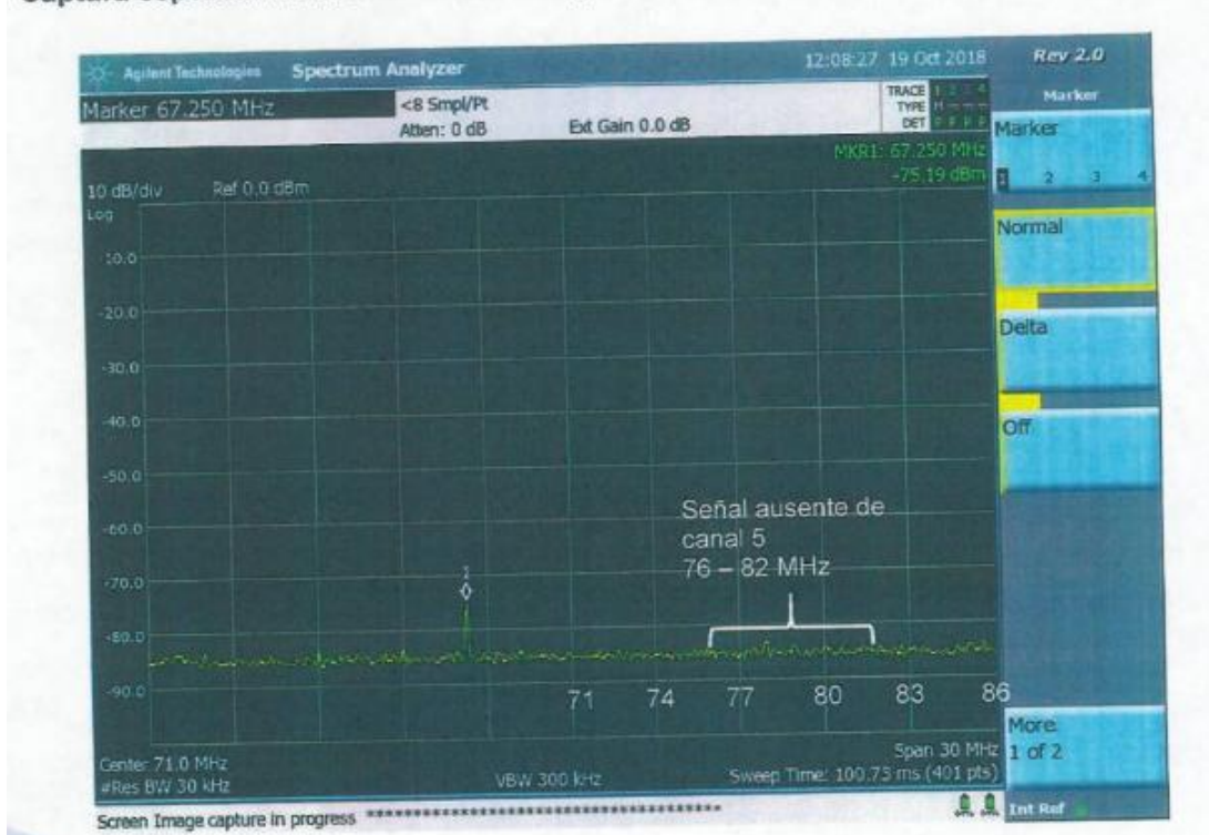
Captura espectral de la señal de canal 5 (76 – 82 MHz):
