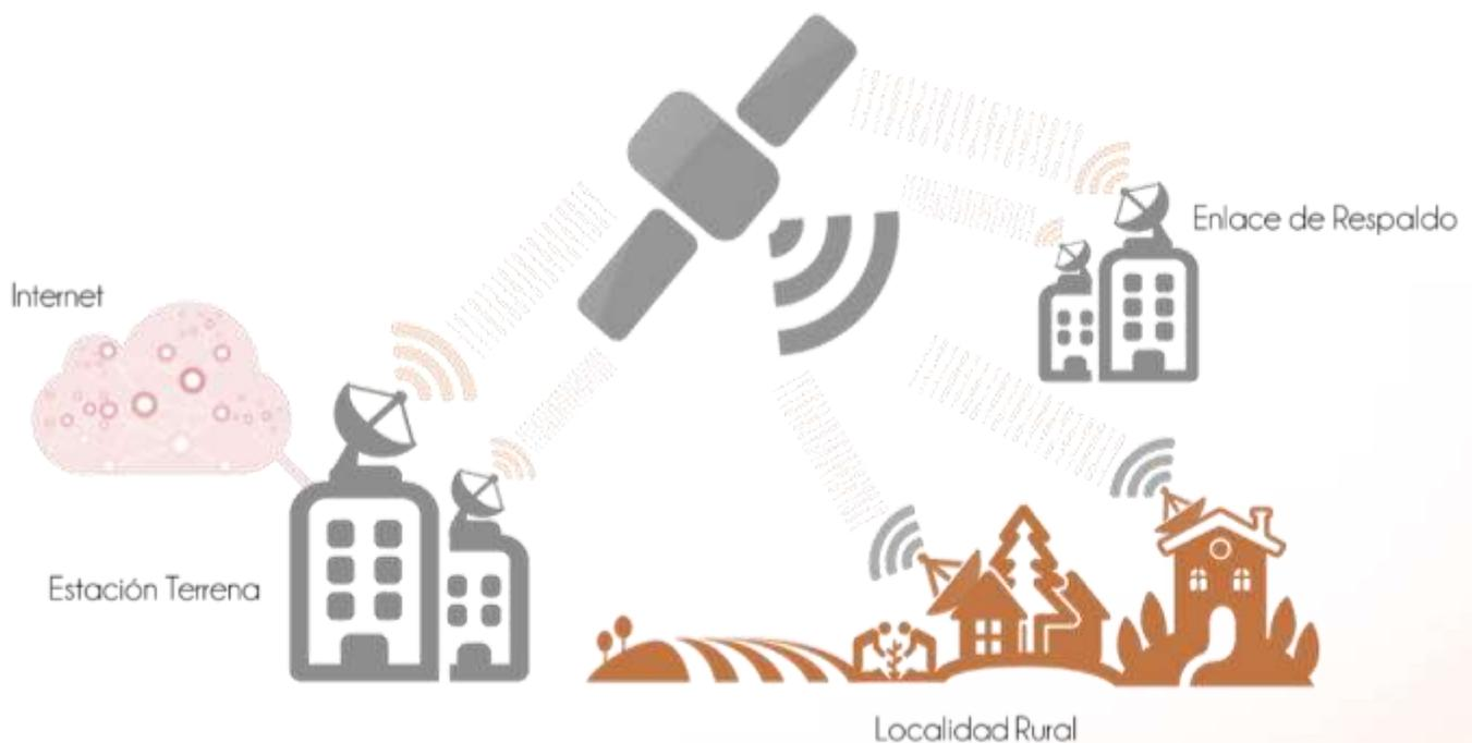
Figura# . Funcionamiento Internet Satelital y enlaces de respaldo
