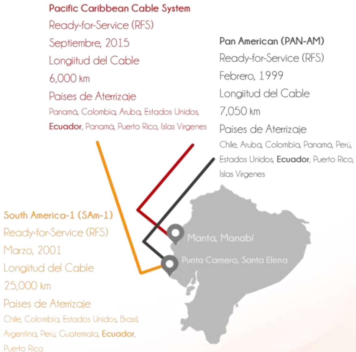
Figura# . Cables Submarinos a los que se conecta Ecuador [7]
